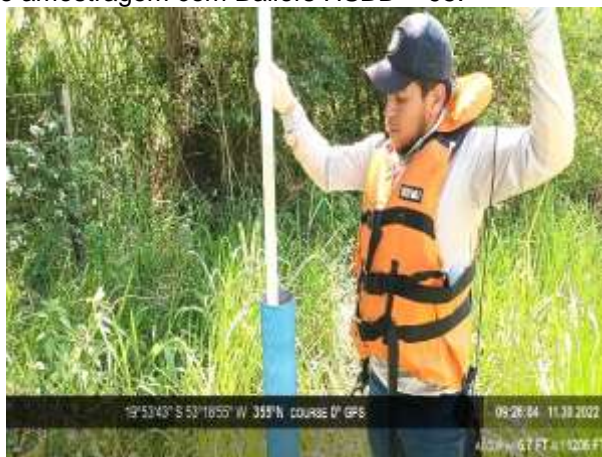
Figura 4 - Procedimento de amostragem com Bailers HSBD – 95.
