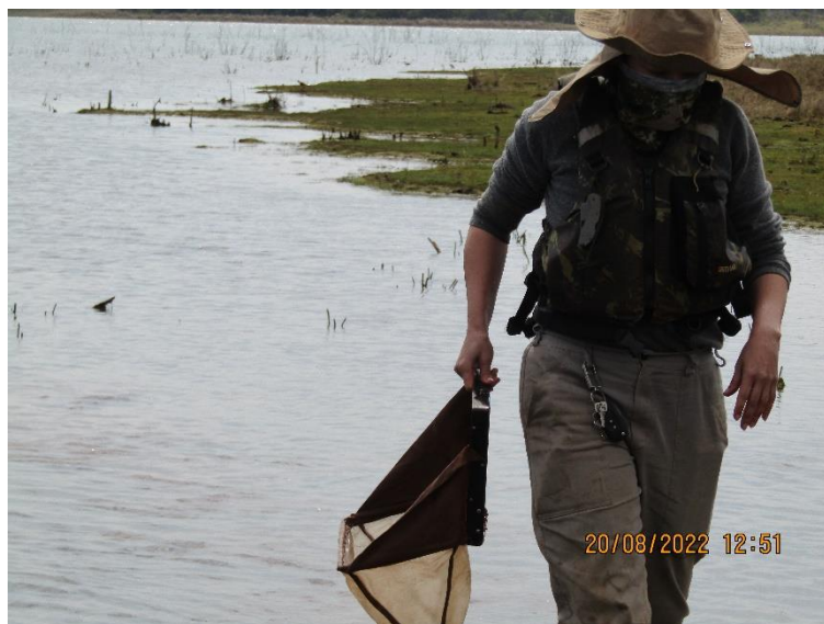
Figura 8. Amostrador do tipo surber utilizado em habitat marginal do trecho de transição fluvial-limnética do reservatório da PCH Verde 4 em agosto de 2022, para coleta de amostra de zoobentos.
